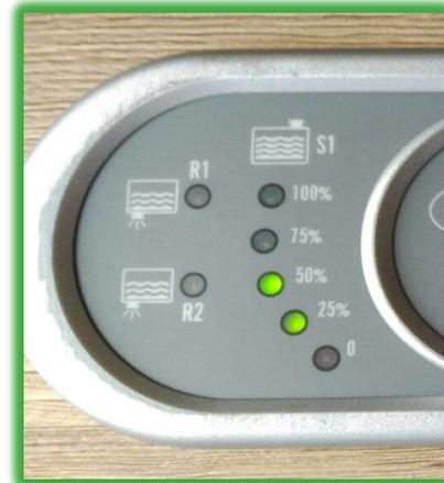
EN LA PARTE IZQUIERDA DEL PANEL DE CONTROL, TENEMOS EL MARCADOR DE NIVEL DE LAS BATERIAS DEL VEHICULO Y DE LA VIVIENDA). MEDIANTE EL BOTON **CHECK** PODREMOS SELECCIONAR SI QUEREMOS COMPROBAR NIVEL BATERIA VEHICULO O DE LA VIVIENDA.
